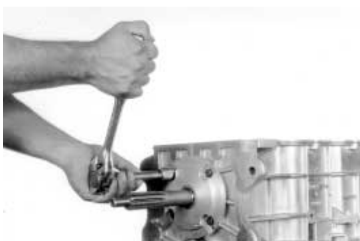
17.- Quite los (4) tornillos del retén balero, como se indica, con un dado de 1/2".
