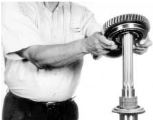
21.- Quite el engrane de reversa y sincronizador, como se muestra.
