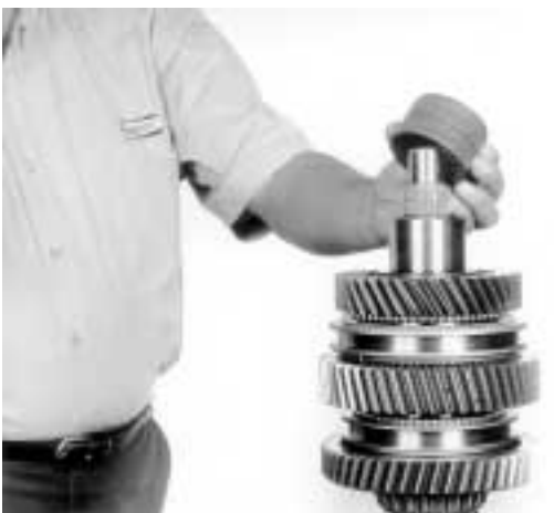
7.- Quite la jaula con rodillos del engrane de 3ª. velocidad, como se indica.
