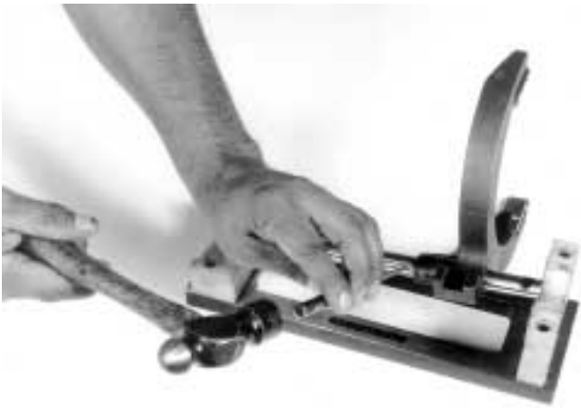
15.- Si es necesario, quite la horquilla botando el perno ayudado de un punzón y un martillo, como se indica.
