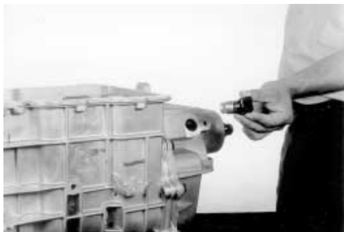
4.- Quite con la mano el sensor del velocímetro, como se muestra.
