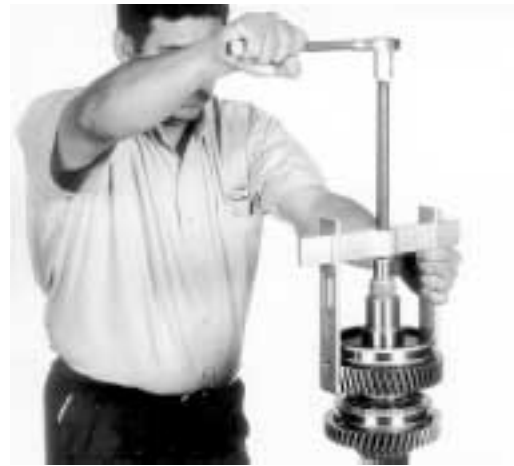
12.- Ayudado de un prensa o extractor de baleros, quite el sincro y el engrane de 1ª. velocidad, como se indica.
