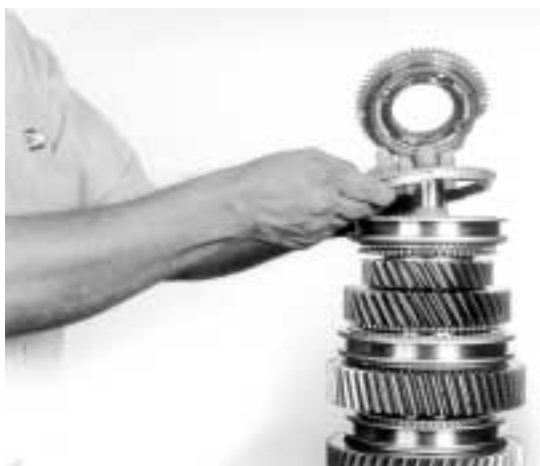
31.- Instale el anillo sincronizador y el cono de embrague de la flecha de mando, como se indica.
