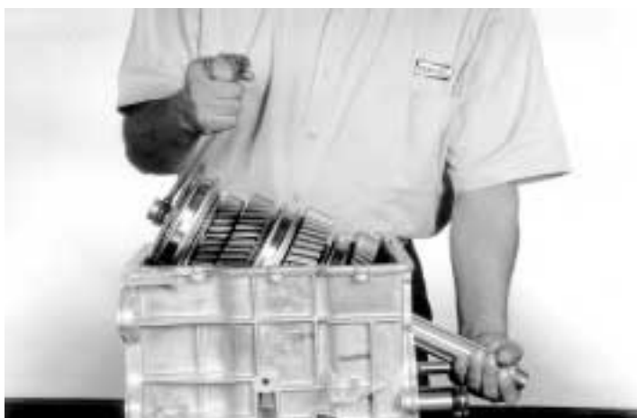
7.- Coloque el conjunto flecha principal sujételo del sincrono levante con una mano ayudado de un cordón y con la otra empuje. Como se indica.
