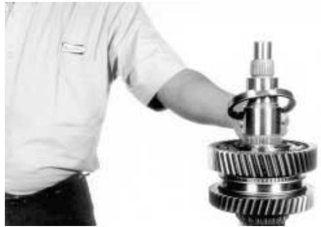
14.- Coloque el cono interior del engrane de 1ª. velocidad, como se muestra.
