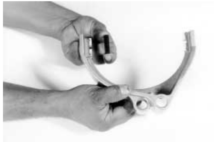
22.- Si los insertos de la horquilla están gastados o muestran ralladuras quítelos, como se muestra
