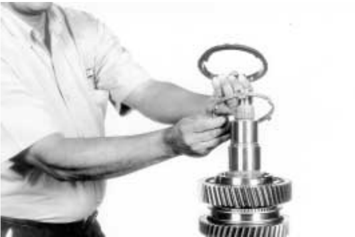
15.- Instale el anillo intermedio y el anillo sincronizador, como se indica.
