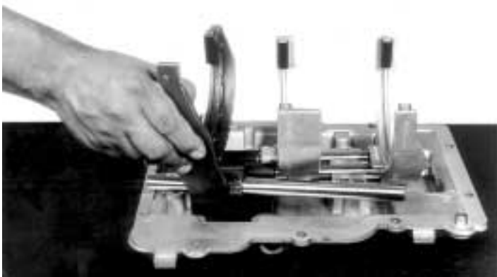
11.- Quite el conjunto barra y horquilla de 5ª. y reversa, como se muestra.
