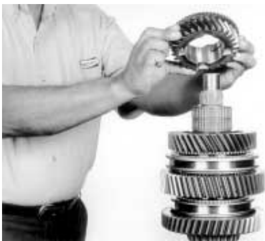
27.- Instale el engrane de 3ª. velocidad, como se indica.
