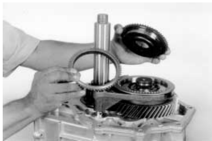
17.- Coloque el anillo sincronizador y el cono del engrane de 5ª. velocidad, como se muestra, lubrique previamente.
