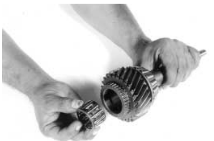
6.- Coloque la jaula con rodillos del balero interior de la flecha de mando, como se muestra.
