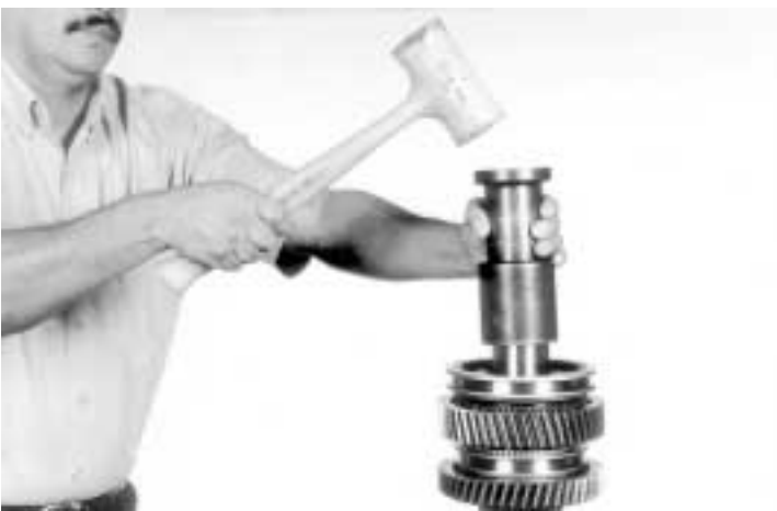
17.- Usando una herramienta impulsora, coloque el conjunto sincronizador de 1ª. y 2ª., como se indica
