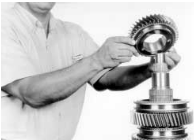
21.- Instale el engrane de 2ª. velocidad, como se indica.
