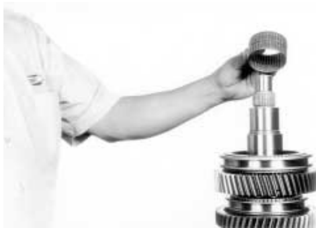
20.- Coloque la jaula con rodillos del engrane de 2ª. velocidad, como se muestra.
