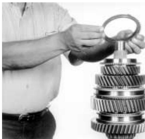
28.- Coloque el anillo sincronizador de 3ª. velocidad, como se muestra, lubrique previamente.
