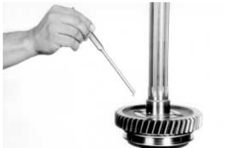
20.- Ayudado de un imán, quite la esfera de arrastre del engrane de reversa, como se indica.
