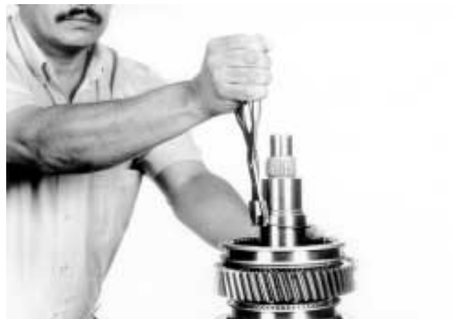
18.- Ayudado con una pinza para seguros, coloque el seguro de la maza del sincronizador, como se muestra.
