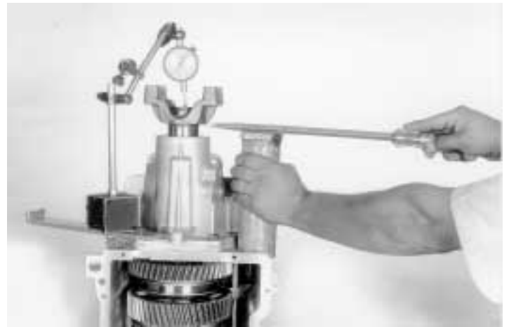
29.- Coloque la transmisión como se indica, ponga un indicador de carátula y cheque el juego axial, como se muestra.
