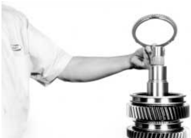
19.- Instale el anillo sincronizador del engrane de 2ª. velocidad, como se indica, lubrique previamente, localice las ranuras de los insertos.
