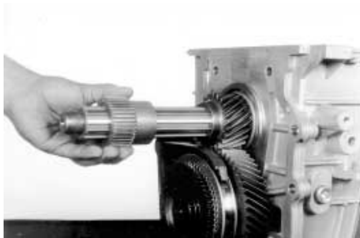
21.- Coloque el engrane velocímetro, como se indica
