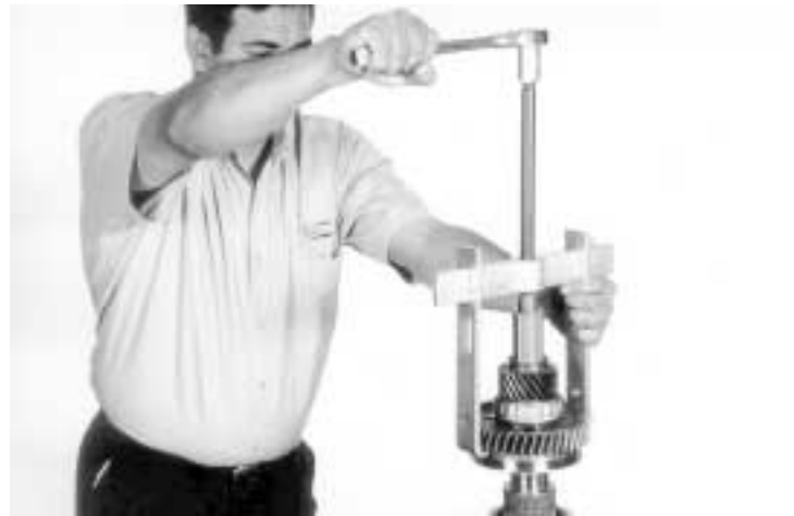
18.- Invierta la posición de la flecha principal a que el engrane de 5ª. Quede arriba, y ayudado de una prensa o extractor, saque el engrane de 5ª. velocidad, como se indica.
