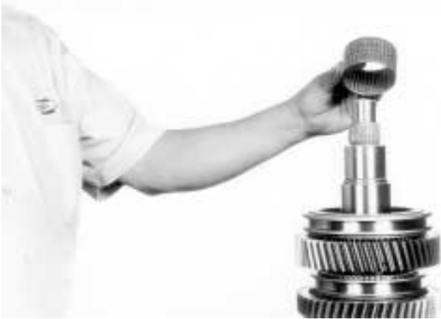
9.- Quite la jaula con rodillos del engrane de 2ª. velocidad, como se indica
