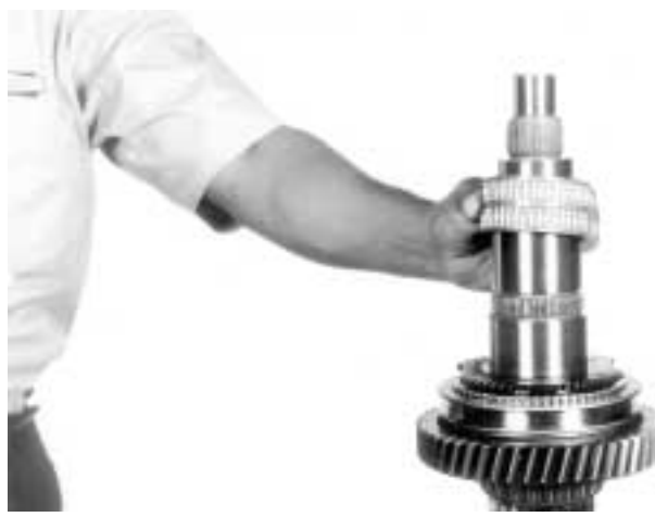
12.- Invierta la posición de la flecha principal a que el engrane de 5ª. quede abajo, y coloque la jaula de rodillos del engrane de 1a. velocidad, como se indica.
