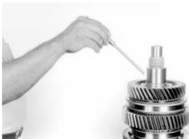
22.- Coloque la esfera de arrastre de la roldana del engrane de 2ª. velocidad, como se muestra.
