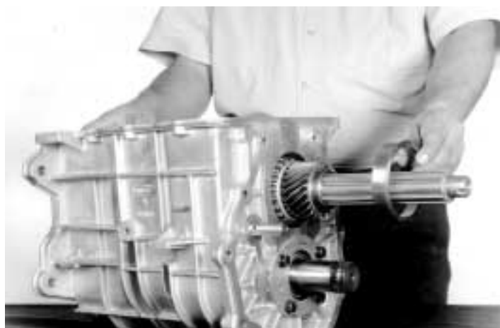
8.- Coloque la taza del balero cónico, como se muestra.
