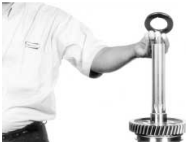
8.- Coloque la roldana de empuje del engrane de reversa, como se muestra.
