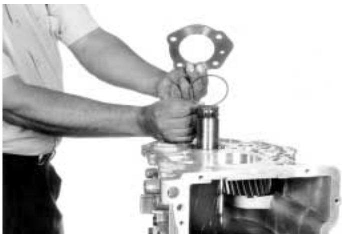
7.- Coloque la(s) lina(s) de ajuste y el retén balero trasero, como se indica.
