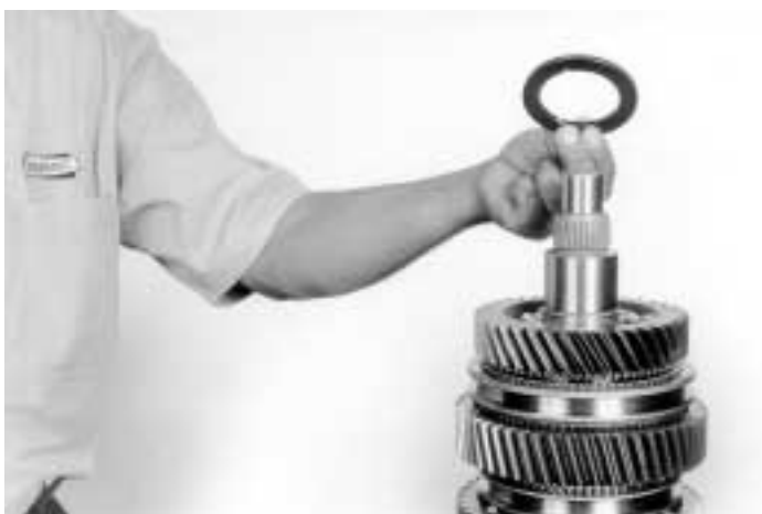
23.- Instale la roldana de empuje del engrane de 2ª. velocidad, como se indica
