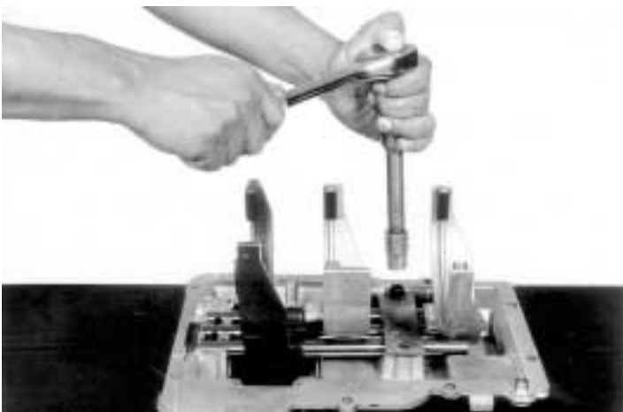
13.- Apriete los (2) tornillos de la placa soporte del sistema de encastre, con un dado de 1/2"
