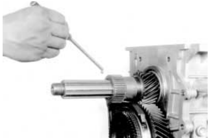
8.- ayudado de un imán quite la esfera de arrastre del engrane velocímetro, como se muestra.
