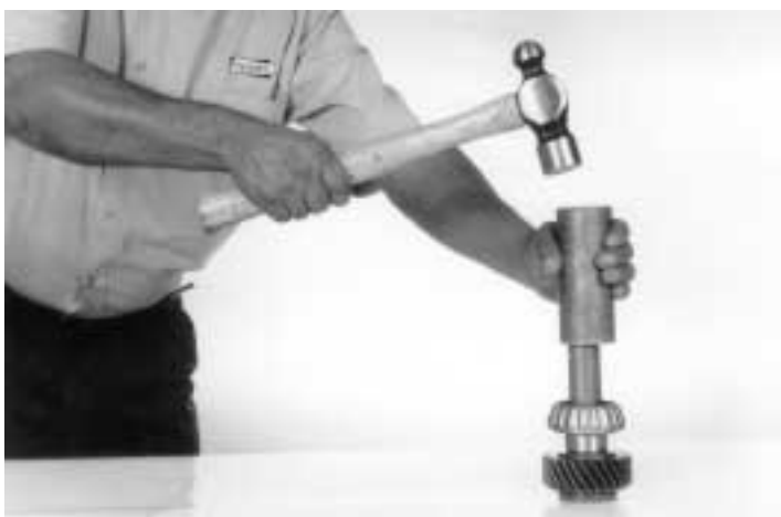
5.- Instale el cono del balero cónico de la flecha de mando, usando una herramienta impulsora o una prensa hidráulica, como se indica.
