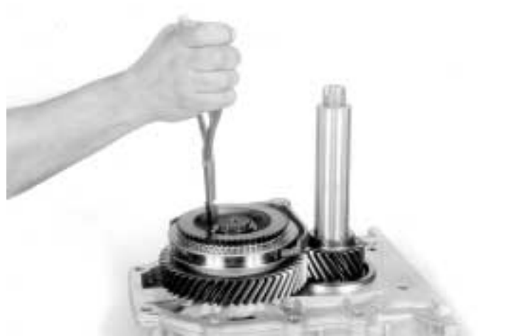
10.- Coloque la transmisión como se muestra, sobre dos maderas y con una pinza para seguros, quite el seguro que sujeta el cono de 5ª.
