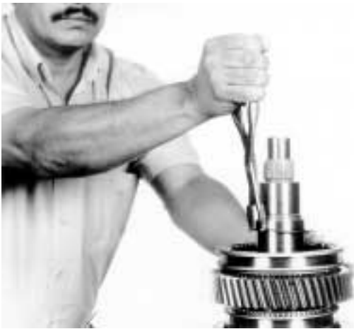
11.- Con una pinza para seguros quite el seguro de la maza del sincro de 1ª. y 2ª., como se muestra.
