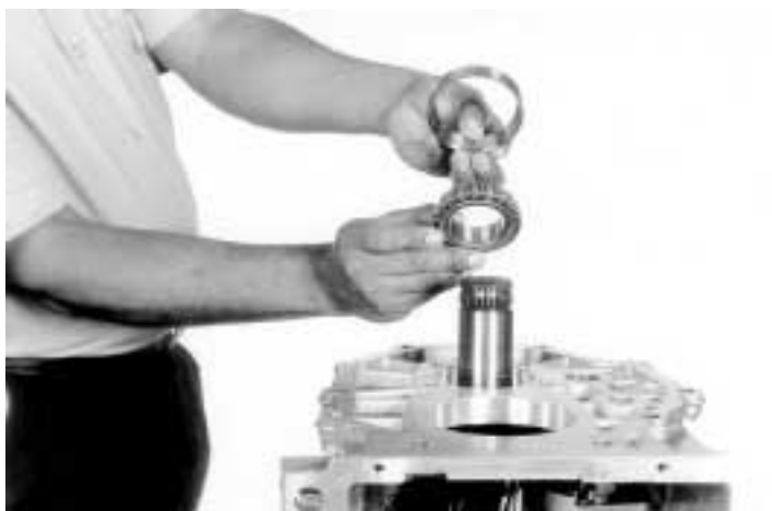
7.- Quite la taza y el cono del balero cónico trasero del tren de engranes.
