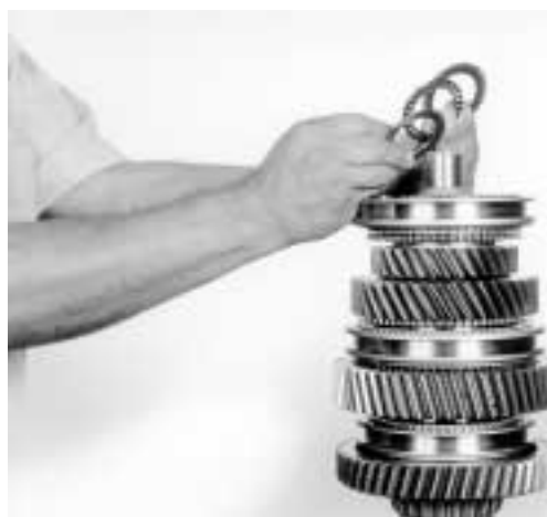
30.- Coloque las roldanas pista y el balero de empuje, como se muestra.
