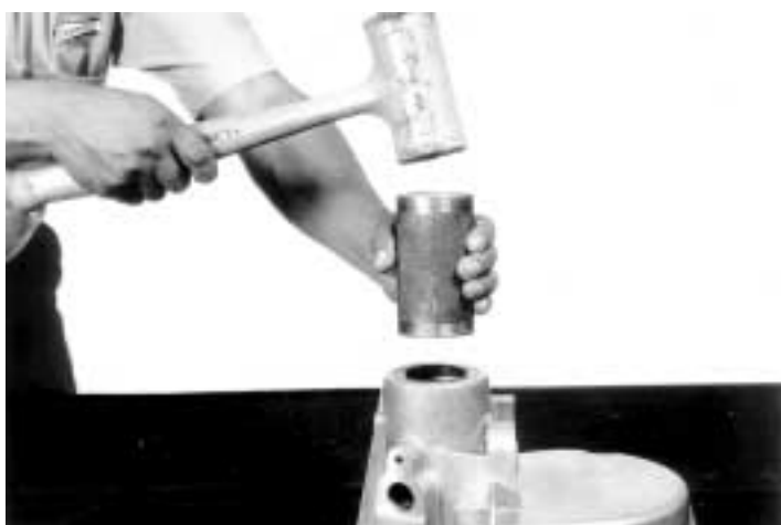
3.- Instale un nuevo sello de aceite para la extensión, si así se requiere usando una herramienta impulsora, como se indica.
