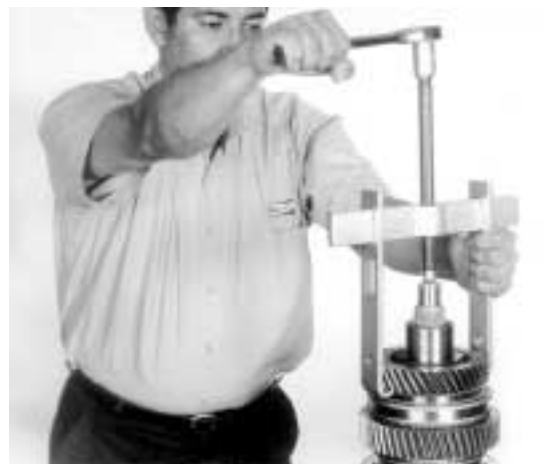
8.- Ayudado de una prensa o extractor de baleros, quite el buje del engrane de 3ª. velocidad, apoyando en el engrane de 2ª, como se muestra.
