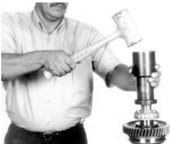
9.- Usando una herramienta impulsora o una prensa hidráulica, coloque el cono balero, como se indica.
