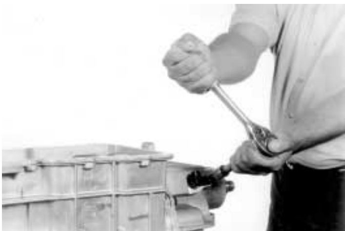
3.- Quite el tornillo que sujeta al sensor del velocímetro, con un dado de 10 mm
