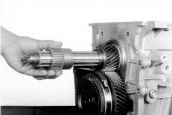
9.- Quite el engrane velocímetro, como se indica.
