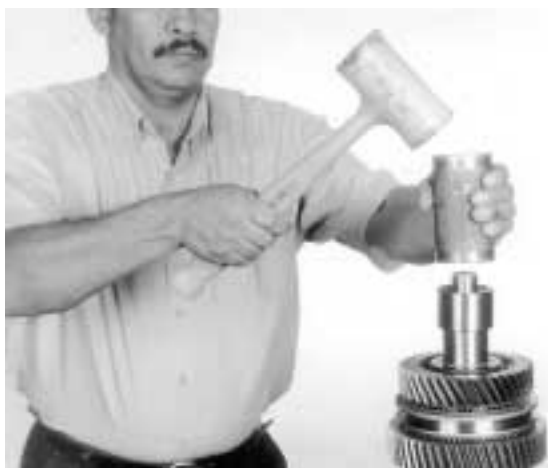
25.- Usando una herramienta impulsora o una prensa hidráulica, instale el buje del engrane de 3ª. velocidad, como se indica
