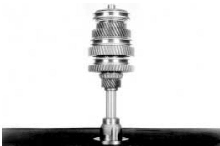
32.- Queda armado el conjunto flecha principal, como se muestra.
