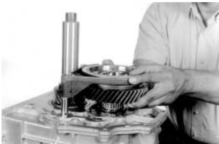
13.- Quite el conjunto sincronizador de 5ª. velocidad junto con la horquilla.
