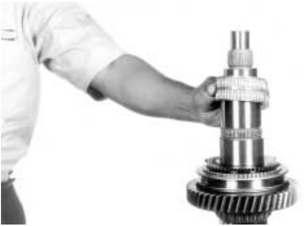
17.- Quite la jaula con rodillos del engrane de 1ª. velocidad, como se muestra.
