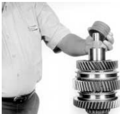
26.- Coloque la jaula de rodillos del engrane de 3ª. velocidad, como se muestra.
