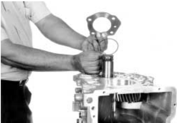
3.- Quite el retén trasero y las laines de ajuste, como se indica.
