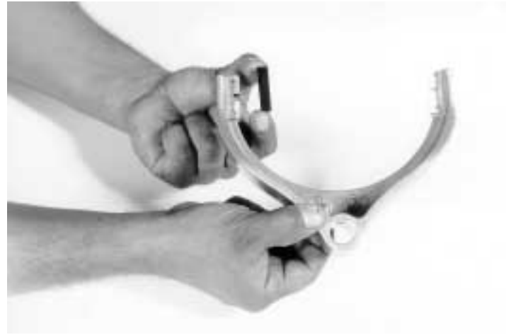
20.- Si los insertos de la horquilla están gastados o muestran ralladuras quítelos, como se muestra
