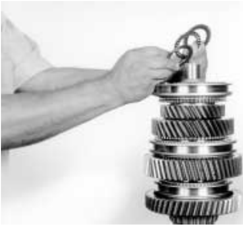
3.- Quite las roldanas pista y el balero de empuje, como se indica.
