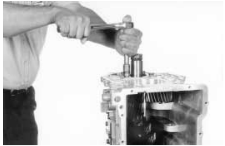
2.-Quite los (4) tornillos del retén trasero, como se muestra, con un dado de 9/16".
