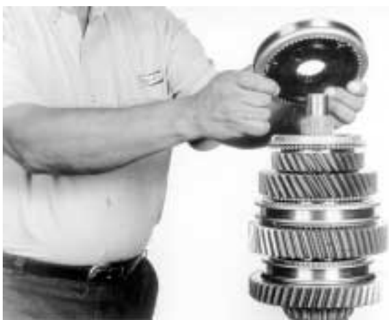
29.- Instale el conjunto sincronizador de 3ª. Y 4ª., como se indica, gire el conjunto para asentar o localizar las ranuras de los insertos.
