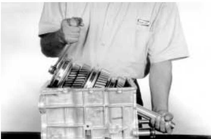
23.- Para sacar el conjunto de la flecha principal sujételo del sincro levante con una mano ayudado de un cordón y con la otra empuje. Como se muestra.
