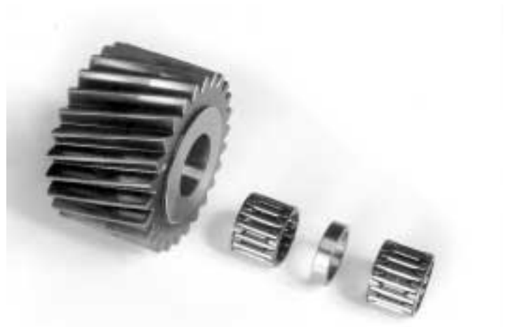
6.- Quite las (2) jaulas con rodillos y el espaciador, como se muestra.
