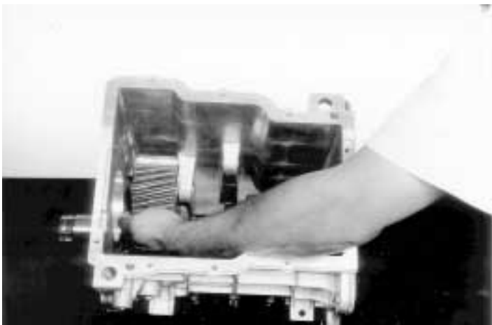
5.- Saque el engrane de reversa, como se indica.
