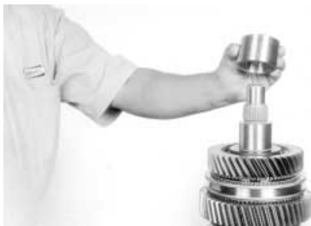
24.- Coloque el buje del engrane de 3ª. velocidad, como se muestra.
