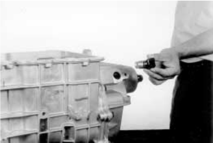
37.- Si es el caso coloque el sensor del velocímetro, como se indica.
