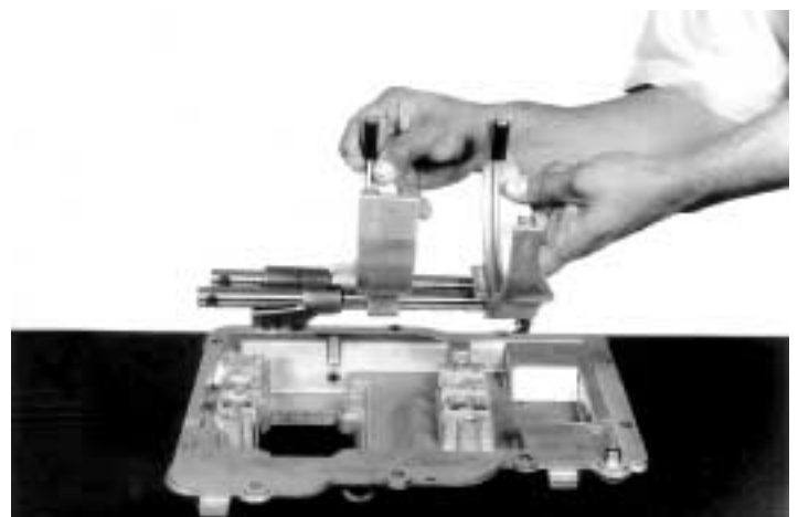
12.- Quite el conjunto restante con las barra, horquillas y topes, como se indica.
