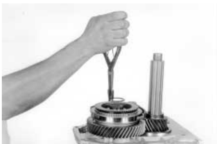
18.- Ayudado de una pinza para seguros, instale el seguro del cono de embrague de 5ª. velocidad.
