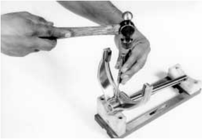
19.- Si es necesario, quite la horquilla botando el perno ayudado de un punzón y un martillo, como se indica.
