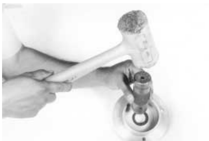
4.- Instale un nuevo sello de aceite para el retén, si así se requiere usando una herramienta impulsora, como se muestra.
