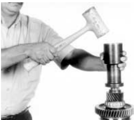
11.- Usando una herramienta impulsora o una prensa hidráulica, coloque el engrane de 5ª. velocidad, como se indica
