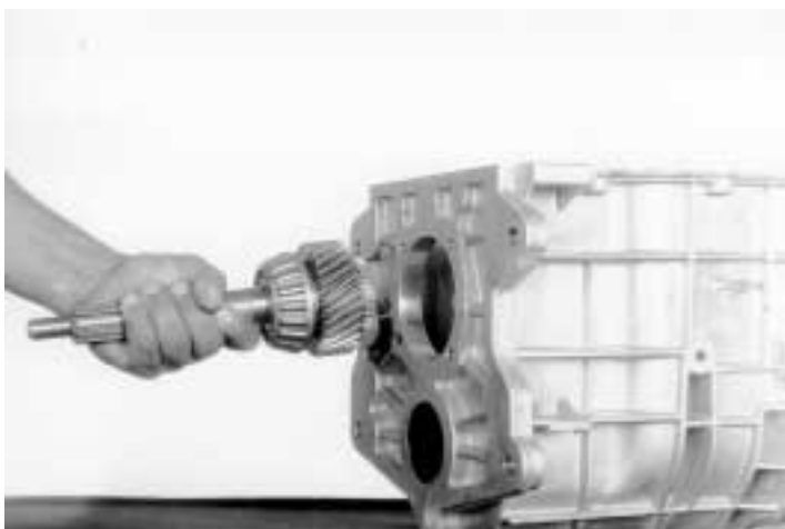
9.- Instale la flecha de mando, localice las ranuras de lubricación de la flecha con el cono de embrague, como se muestra.
