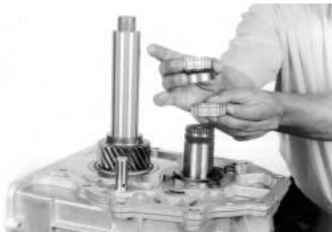
14.- Quite los dos baleros de rodillos y el espaciador, como se indica.
