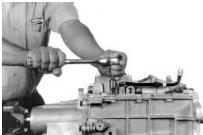
18.- Apriete lo (10) tornillos de la tapa de control, como se indica, con un dado de 1/2.
