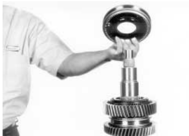
16.- Coloque el conjunto sincronizador de 1ª. y 2ª., como se muestra, gire el conjunto para asentar o localizar las ranuras de los insertos.
