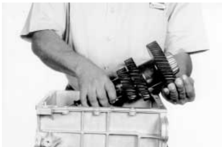
8.- Deslice el tren de engranes hacia atrás y sáquelo de la caja levantándolo, como se muestra.
