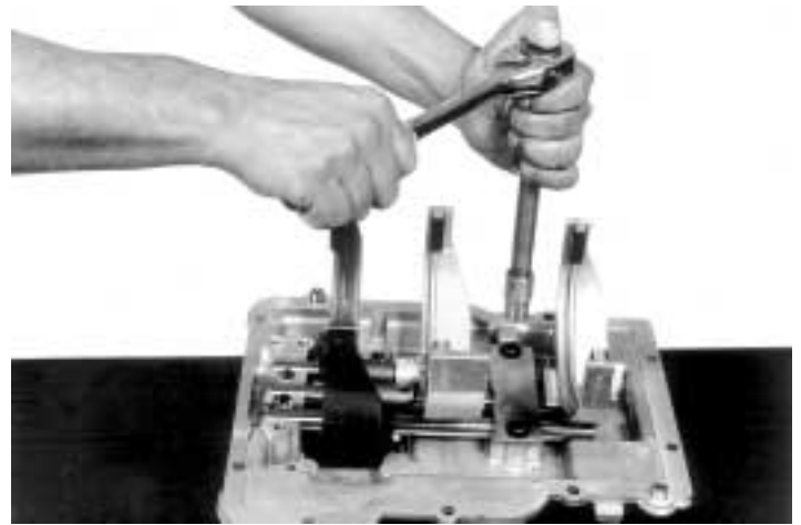
10.- Quite los (2) tornillo de la placa de retención del
