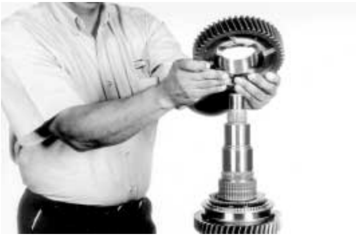
13.- Instale el engrane de 1ª. velocidad, como se indica.
