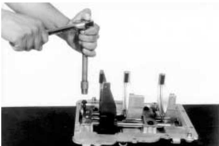
15.- Apriete los (3) tornillos de la placa soporte del sistema de bloqueo, con un dado de 1/2.
