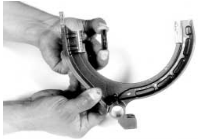
16.- Si los inserto de la horquilla estan gastado o muestran rayaduras quitelos como se muestra, se puede ayudar de un desarmador plano.
