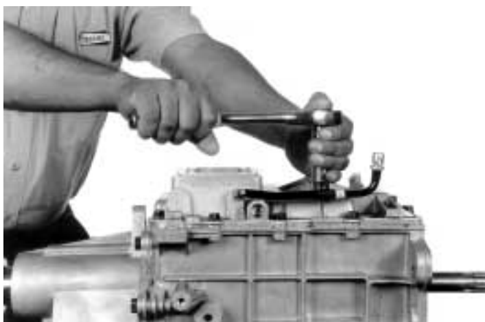
19.- apriete el tornillo del soporte del repiradero, como se muestra, con un dado de 13 mm.
