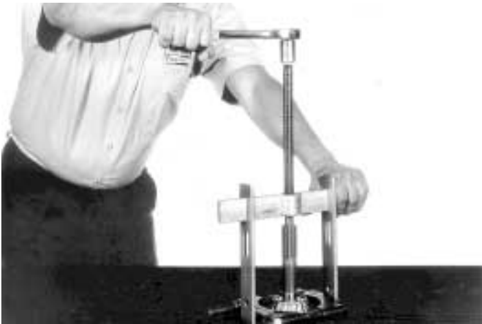
21.- Si es necesario, quite el cono del balero de la flecha de mando, ayudado de un extractor o prensa neumatica, como se muestra.
