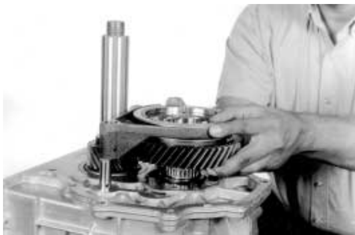
16.- Instale el conjunto sincronizador de 5ª. velocidad junto con la horquilla, como se indica
