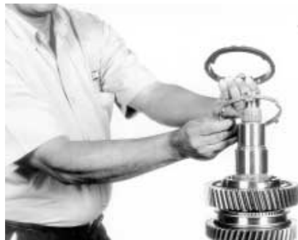
14.- Quite el anillo sincronizador y el anillo intermedio del engrane de 1ª. velocidad, como se indica.
