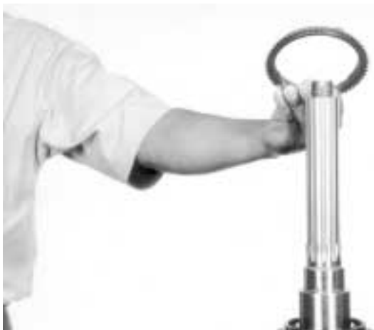
23.- Quite el anillo sincronizador de reversa, como se muestra.
