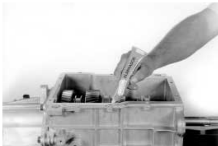
16.- Aplique eliminador de juntas, cuide que la superficie esté limpia de polvo y grasa.
