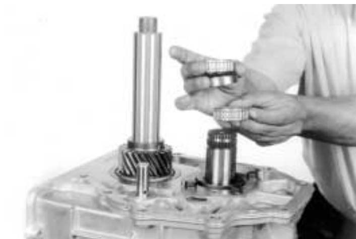
15.- Coloque los dos baleros de rodillos y el espaciador, como se muestra.
