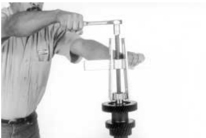
9.- Ayudado de un extractor de balero, quite el cono balero cónico del tren de engranes, como se indica.
