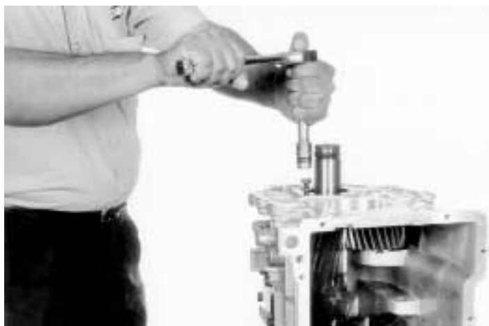
8.- Coloque los (4) tornillos del retén trasero, como se muestra.
