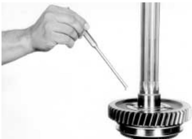
7.- Coloque la esfera de arrastre del engrane de reversa, como se indica.
