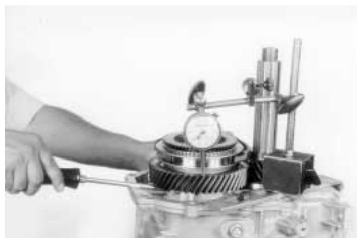
19.- Ayudado de un indicador de carátula inspeccione el juego axial, como se muestra.
