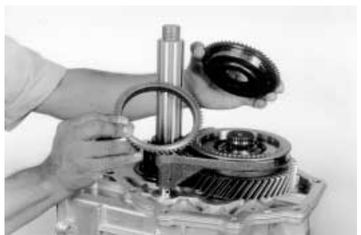
12.- Quite el cono y el anillo sincronizador del engrane de 5ª. velocidad, como se muestra.
