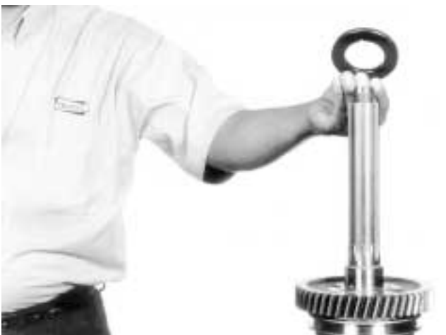
19.- Quite la roldana de empuje del engrane de reversa, como se muestra.
