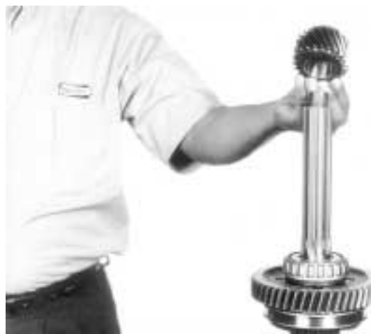
10.- Coloque el engrane de 5ª. Como se muestra.
