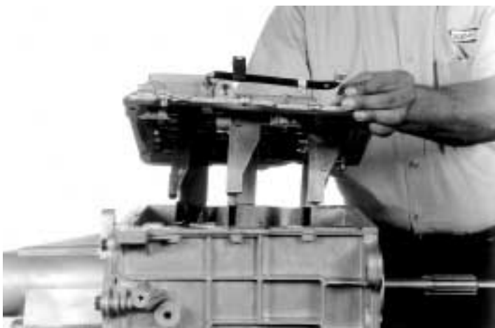
17.- Instale la tapa de control sobre la caja asegurándose de que las horquillas de cambio alineen con los correspondientes sincronizadores.
