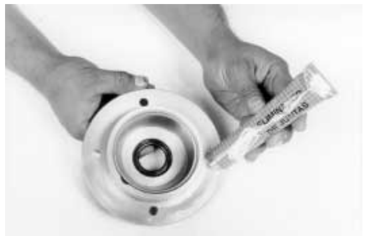
30.- Una vez que se tiene el juego axial, proceda al ensamble definitivo, limpie la superficie del retén balero y aplique eliminador de juntas.
