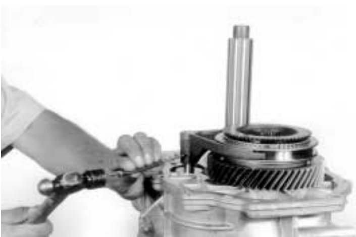
11.- Quite la horquilla de 5ª. velocidad, botando con un punzón y un martillo el perno seguro que le sujeta,
