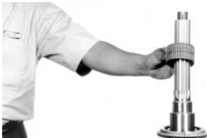
22.- Quite la jaula con rodillos del engrane de reversa, como se indica
