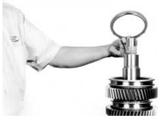
10.- Quite el anillo sincronizador de 2ª. velocidad, como se indica.
