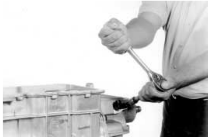
38.- Apriete el sensor del velocímetro, con un dado de 10 mm., como se muestra.
