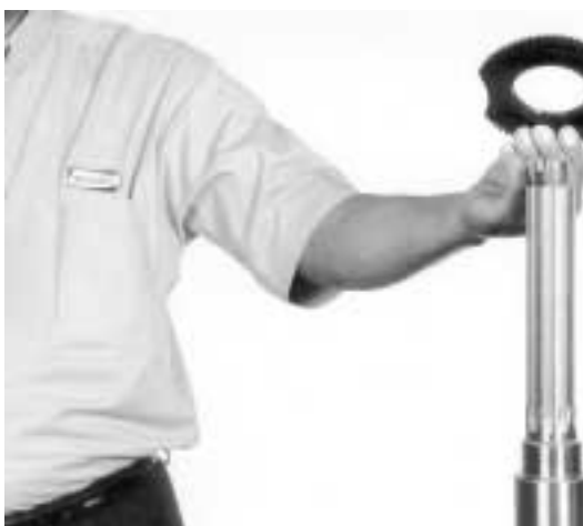
25.- Quite el cono de embrague de reversa, como se muestra.
