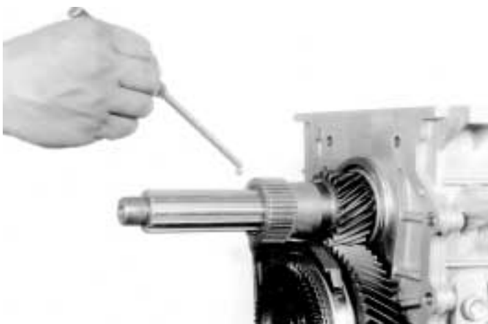
22.- Ponga la esfera de arrastre del engrane velocímetro, como se muestra
