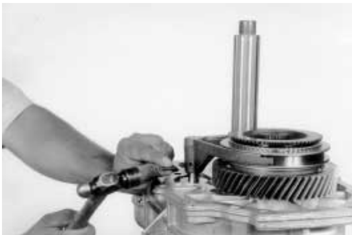
20.- Instale el perno seguro, como se muestra
