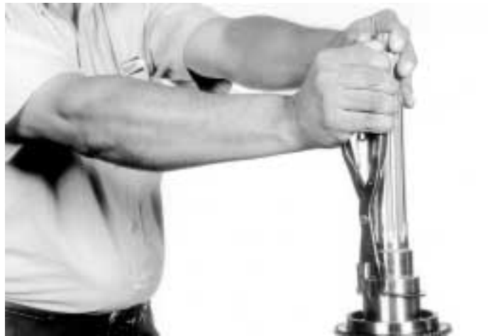
24.- Con una pinza para seguros quite el seguro del cono de embrague de reversa, como se indica.
