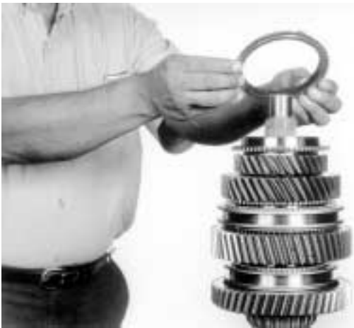
5.- Quite el anillo sincronizador de 3ª. velocidad, como se indica.
